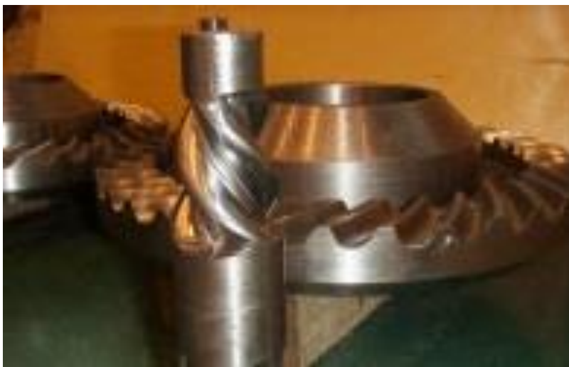
Рис.2 тяговый редуктор тепловоза серии ТЭМ-2
