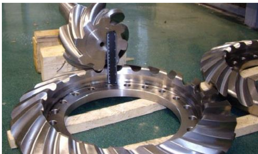
Рис.1 главная передача самосвала БелАЗ-7755 с ЭЦ-зацеплением
