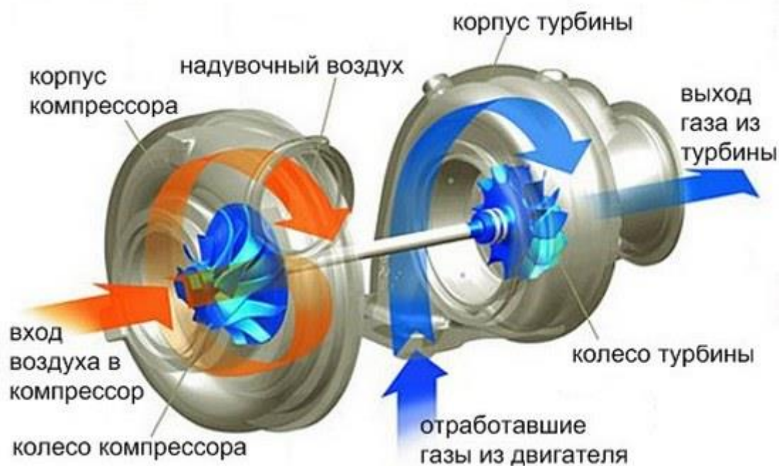
Рисунок 1 – Схема распространения воздуха в турбинном колесе с осевым распределением воздушных потоков
