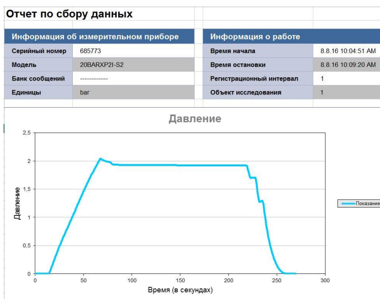
Рис. 1. Пример отчета реометрического контроля диагностической скважины
