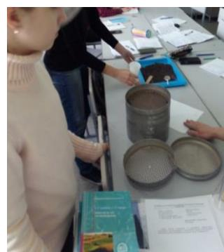
Самый маленький диаметр сит равен 1 мм. Сита вставляются в поддон, засыпается порция почвы (300-500 г), закрываются крышкой и встряхиваются в течение 20 минут, пока пыль полностью оседает. Почву, просеянную через сито с диаметром отверстий **1 мм**, называют **мелкоземом**. Далее почву нужно взвесить, пересыпать в банки с притертymi пробками, бумажные или пластиковые пакеты. Приkleить этикетки. Пробы хранят в помещении.
