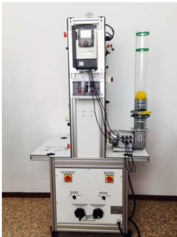
Рисунок 1 – Стенд «Шарик в трубе»
