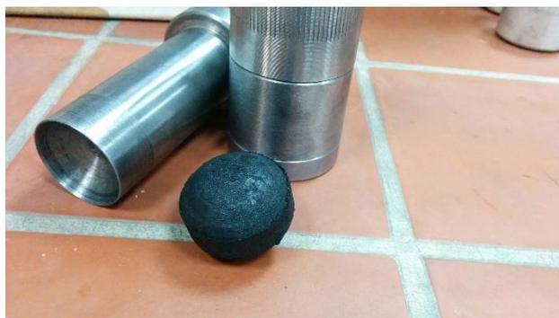
*Рис. Образец брикетированного топлива*
