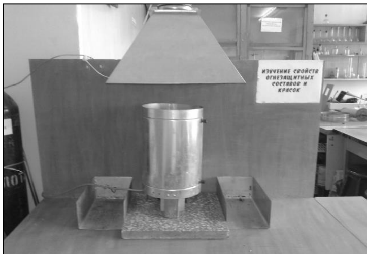
Рис. 1. Лабораторная установка по определению огнезащитных свойств материалов
