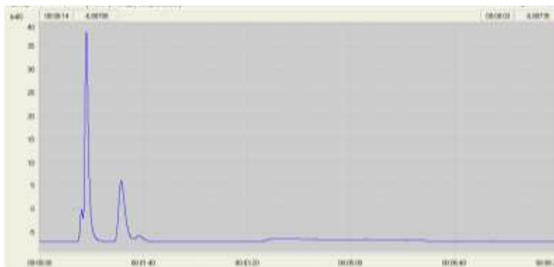
Рис. 2. Хроматограмма газа, выделяющегося при гетерогенном пиролизе твердых гранул топлива
