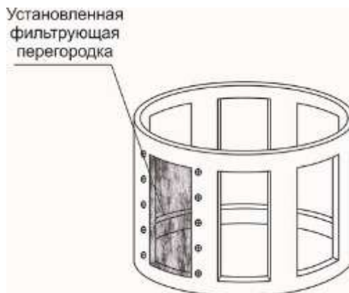
Рисунок 2 – Барабан центрифуги со сменными фильтрующими перегородками
