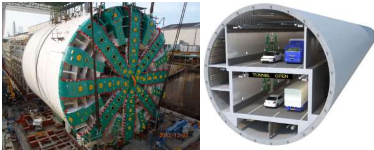
Рис. 3. Тоннелепроходческий комплекс Vertha и тоннель в Сиэтле
