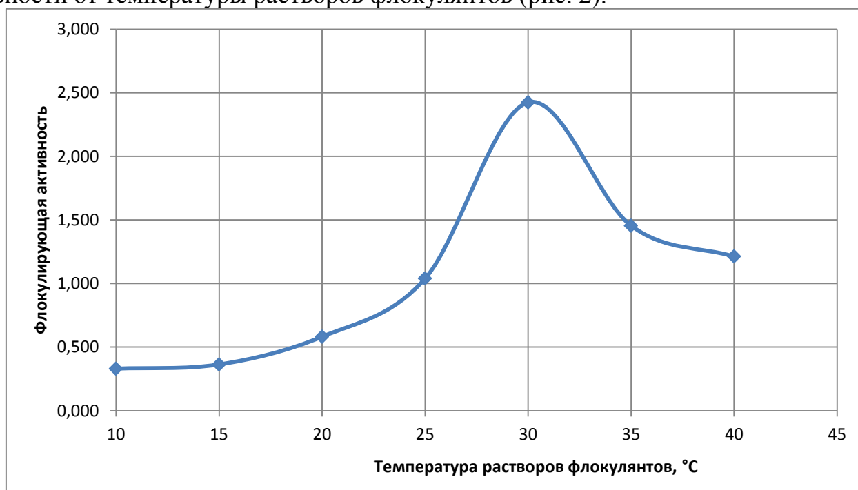
Рисунок 2 – Зависимость флокулирующей активности от температуры флокулянта.
