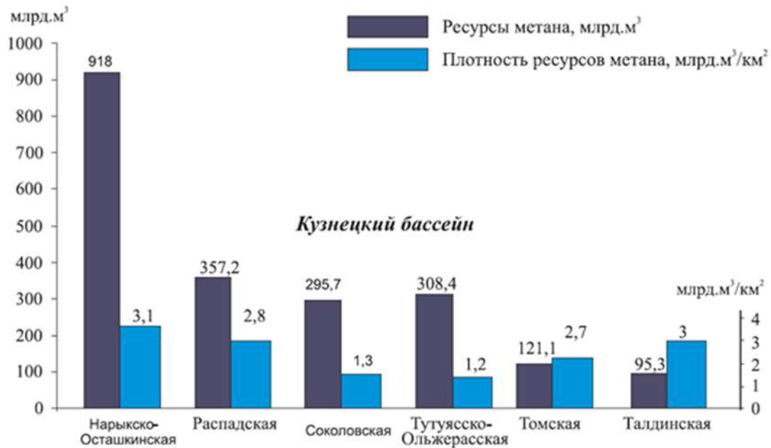
Рис. 4. Распределение ресурсов и плотности ресурсов метана угольных пластов на отдельных месторождениях Кузбасса (по данным ВНИГРИуголь)
