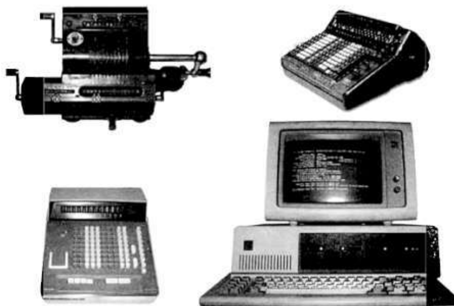
Рис.3. Слева направо и сверху вниз: Brunsviga (1927), Mercedes Euklid (1935), ANITA (1961) и персональный компьютер IBM 1980 года демонстрируют головокружительные темпы развития вычислительных машин в XX веке
