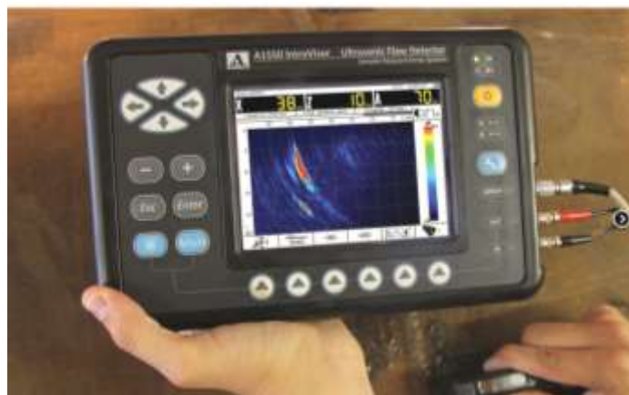
Рис. 2. Ультразвуковой дефектоскоп-томограф A1550 IntroVisor с преобразователем на фазированных решетках
