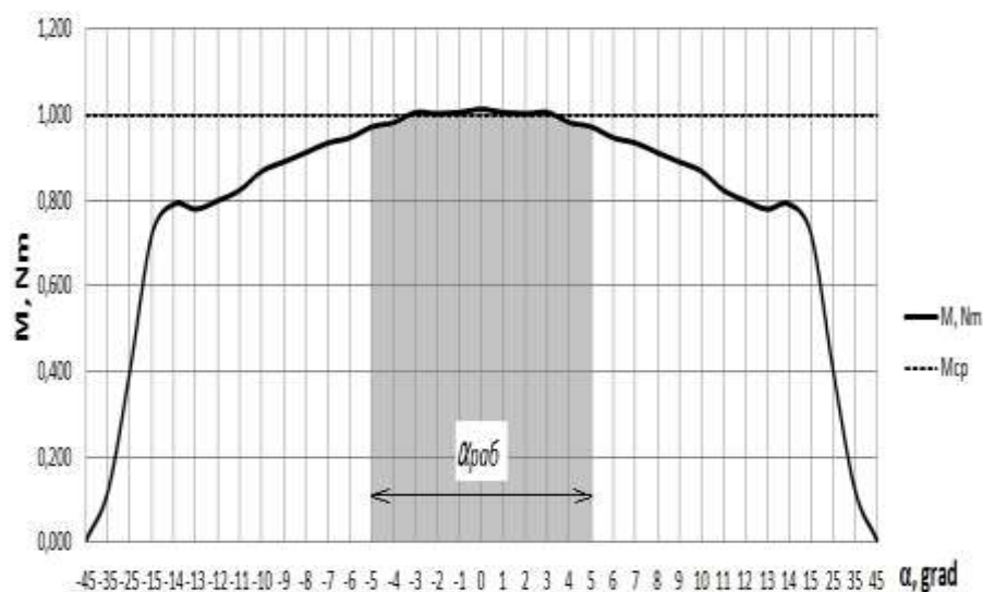
Рисунок 3 – Кривая момента во всем диапазоне поворота ротора. M_{ср} – среднее значение момента в рабочей области.
