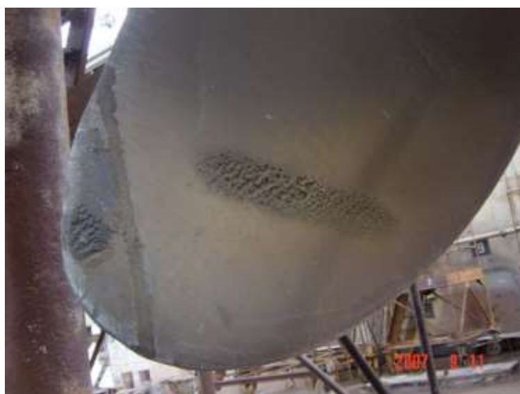
Рис. 2. Последствие кавитации на лопасти судового гребного винта [2]
