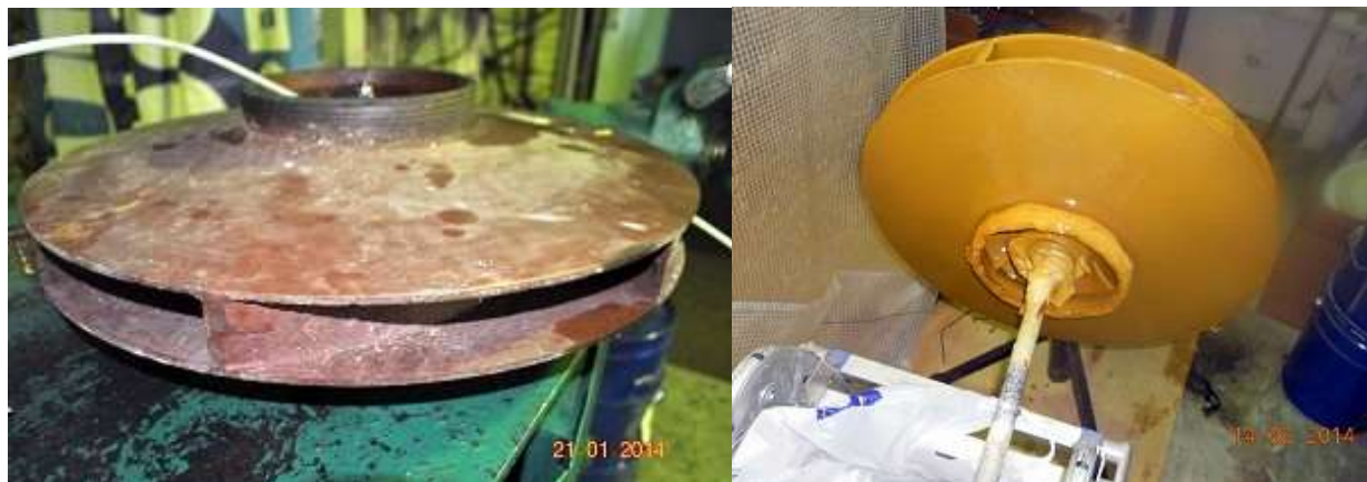
Рис. 3. Деталь до и после нанесения эластомерного покрытия [7]
