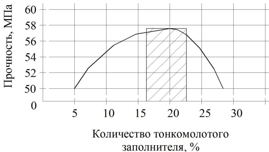
Рис. 5. Зависимость прочности тяжёлого бетона от количества тонкомолотого заполнителя.
