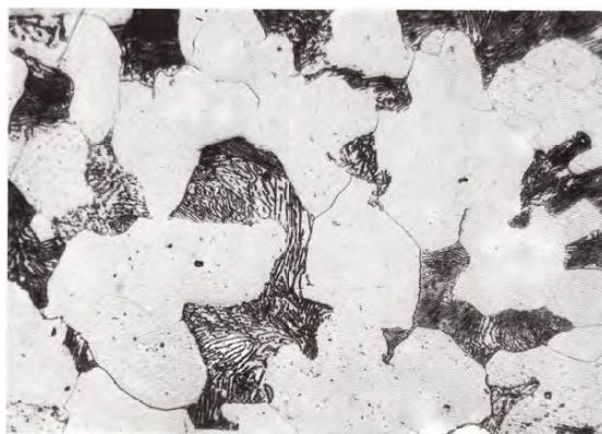
Рис. 2. Микроструктура исходного состояния стали 35Л
