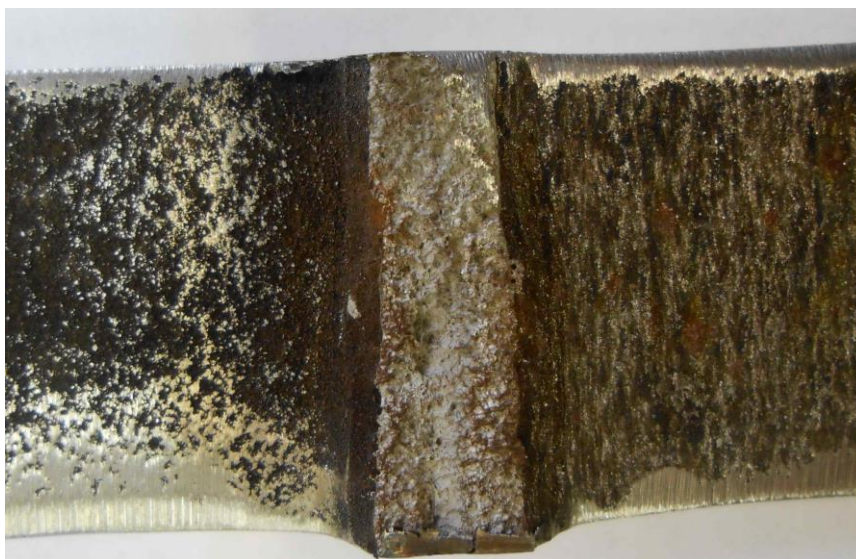
Рис. 1. Внешний вид поверхности реактора синтеза карбомида, подверженной коррозионному износу
