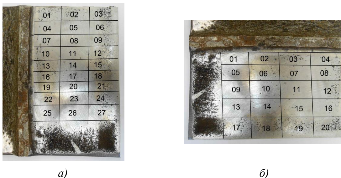
Рис. 2. Схема замеров акустических характеристик с образца металла реактора синтеза карбомида a – поперек образца; b – вдоль образца
