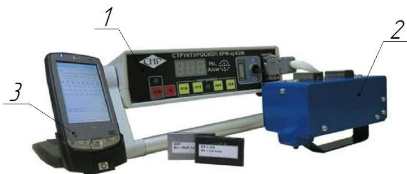
Рис. 5. Внешний вид магнитного структуроскопа КРМ-Ц-К2М: 1 – структуроскоп; 2 – преобразователь; 3 – карманный персональный компьютер
