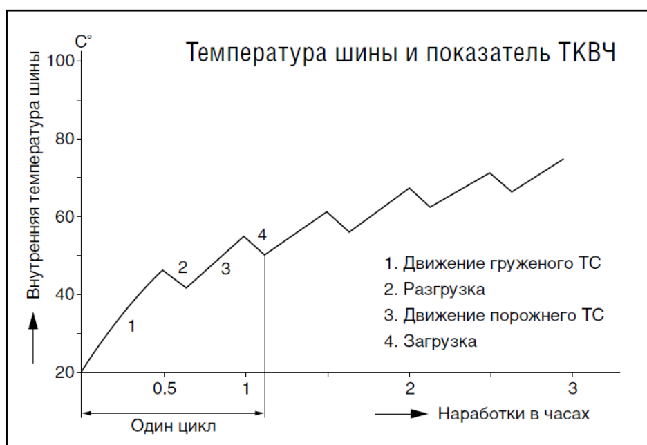
Рисунок 2 – Зависимость внутренней температуры шины от показателя ТКВЧ
