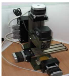
Рис. 2. Микрофрезерный станок модели PROXXON MF-70
