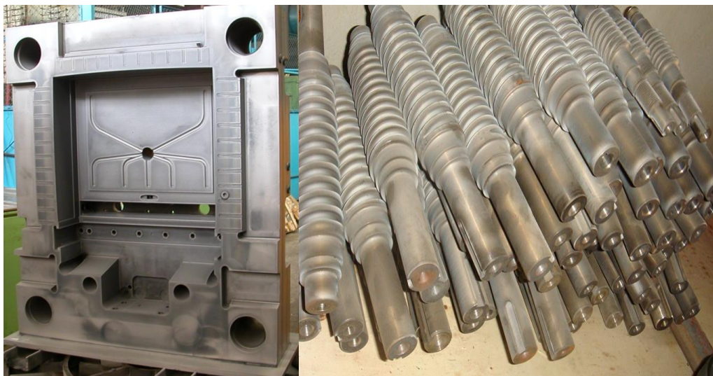
Рисунок 2 – Стальные изделия после ионно-плазменного азотирования
