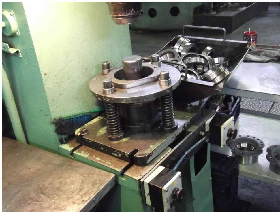
Рисунок 6. Технологическая оснастка для сборки конических подшипниковых узлов на ОАО "КАМАЗ" (2014 г.).
