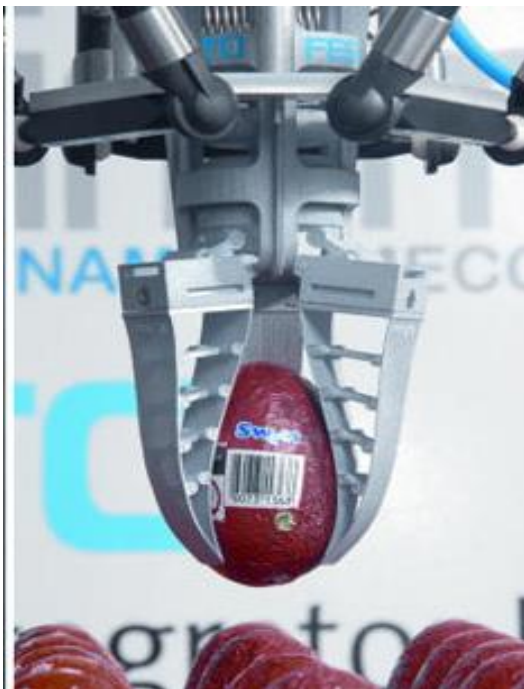
Рис. 5. Пластины – основа 3У Festo FinGripper
