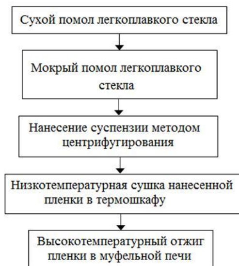
Рисунок 1 – Технологический маршрут получения кремний – стекловидный диэлектрик
