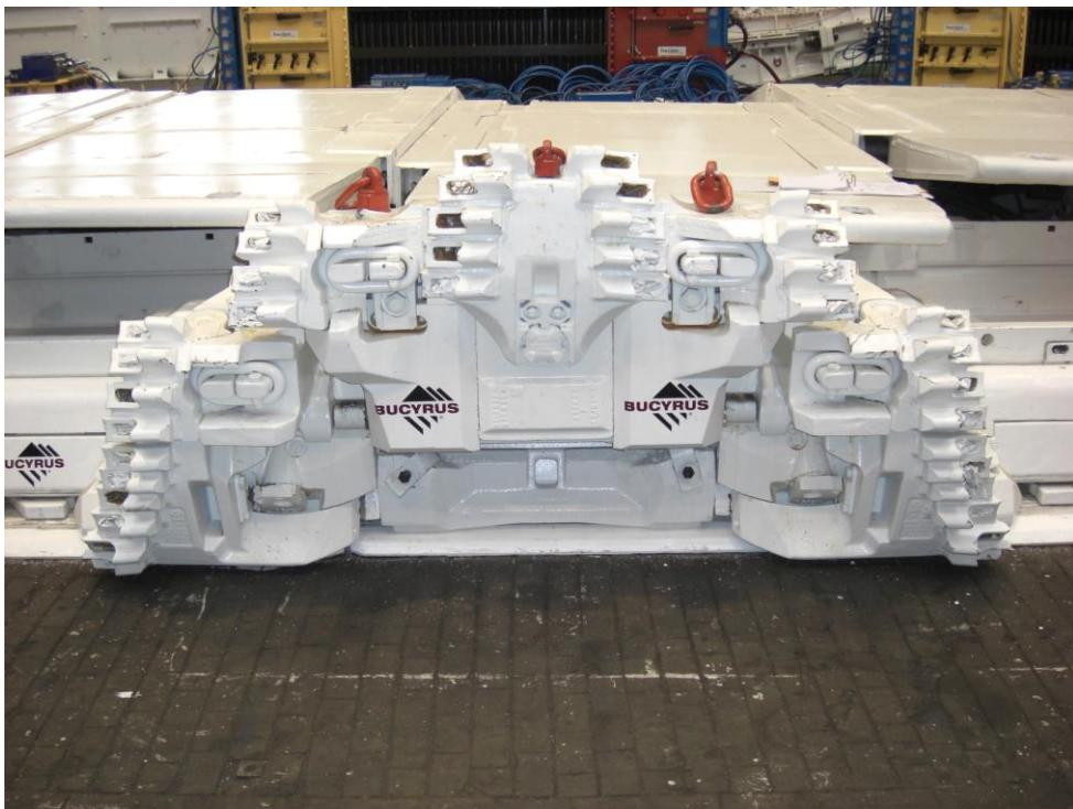
В данный момент большинство шахт Кемеровской области ведут отработку угольных пластов выемочными комбайнами. Но струговый комплекс постепенно находит свое применение на угольных предприятиях отрабатываемых маломощные пласти. В Кузбассе отработку лав стругом, помимо шахты «Первомайская» ведут шахта «Новая» (г. Ленинск-Кузнецкий) и шахта «Березовская».
