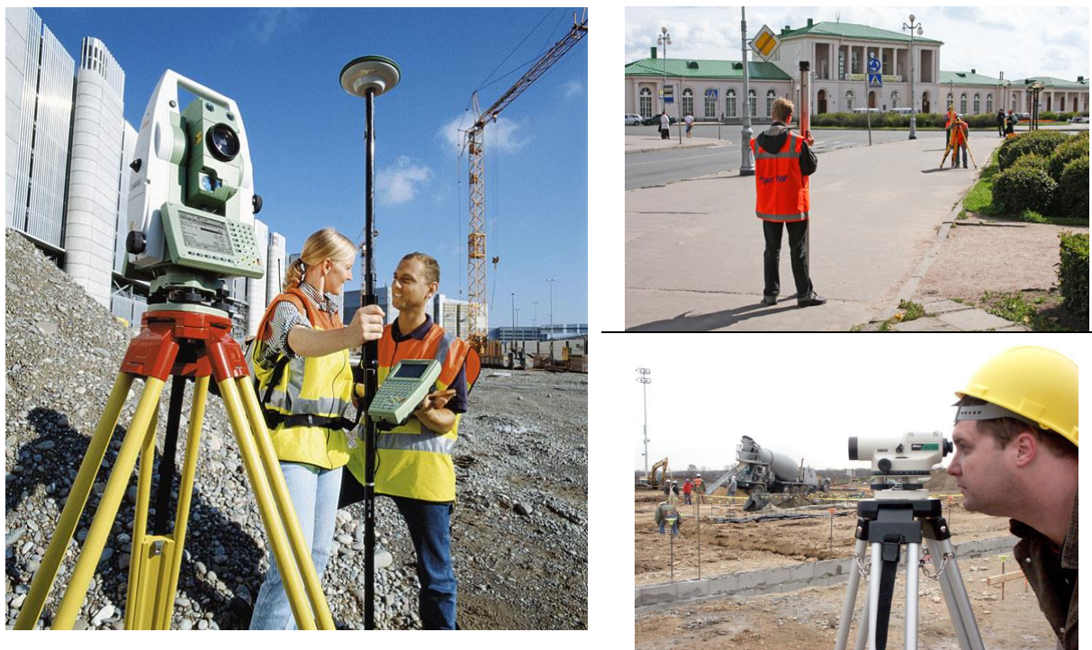
Рис. 4. Электронная тахеометрия, нивелирование и спутниковое позиционирование
