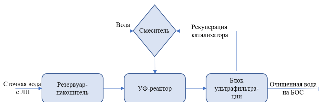
Рисунок 2. Блок-схема внедрения фотокаталитического модуля в существующую систему очистки сточных вод
