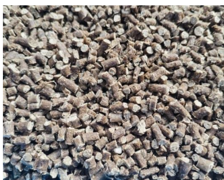
Рисунок 4. Общий вид гранул ПКМ, полученного из смешанных полимерных отходов и волокон
