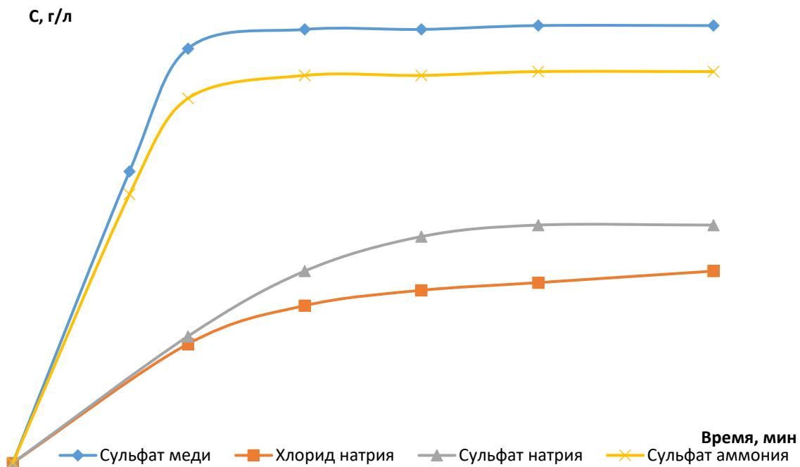
Рисунок – Кривые выбираемости красителя прямого коричневого в присутствии разных электролитов
