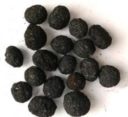
Рисунок 2. Внешний вид магнитного сорбента из углеродсодержащих отходов
