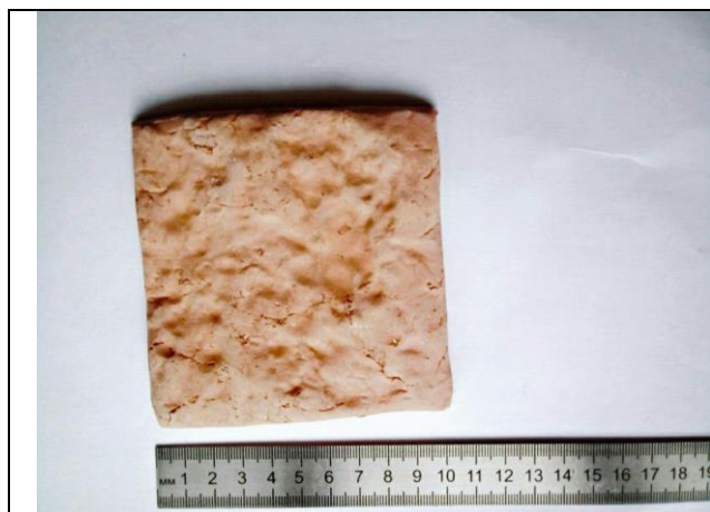
Рисунок 2. Терракотовая керамическая плитка квадратной формы с рельефной неглазурованной поверхностью.
