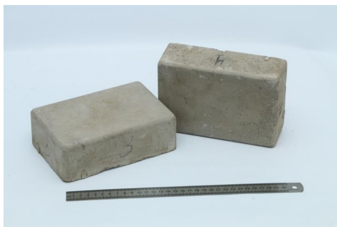
Рисунок 1. Серая тротуарная плитка с добавками осадков химической водоподготовки
