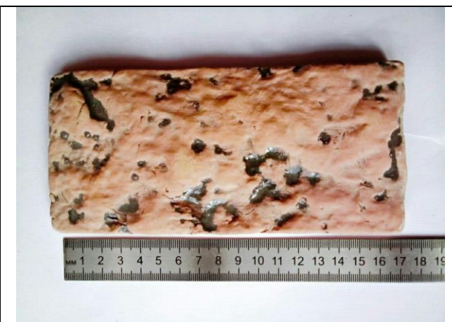
Рисунок 3. Терракотовая керамическая плитка прямоугольной формы с рельефной глазурованной поверхностью.
