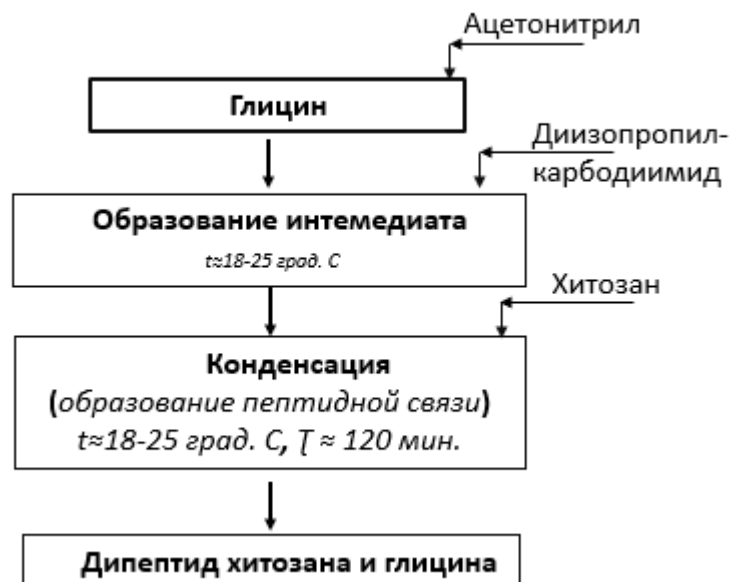
Рисунок 3. Схема получения хитозана, модифицированного глицином
