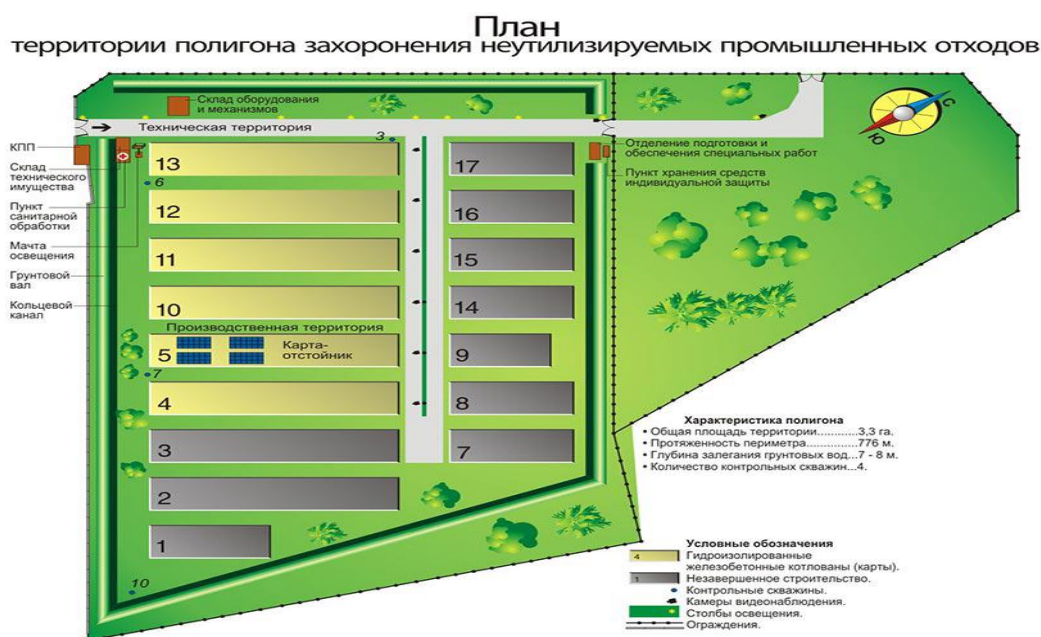
Рисунок 1. План территории полигона захоронения не утилизируемых промышленных отходов
