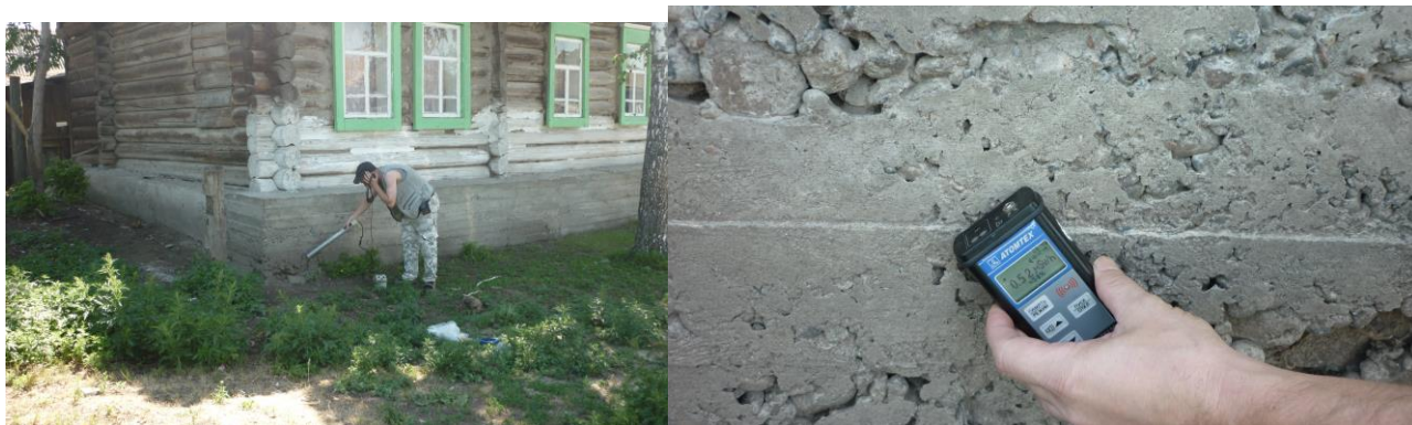
Рис. 4. «Часть аномалий приурочена к существующим строениям»: слева – обследование фундамента жилого дома; справа – и вот результат – 0,52 мкЗв/ч на поверхности фундамента
