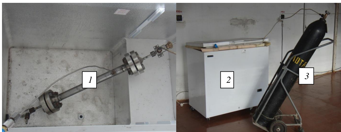
Рис. 1. Установка охлаждения углеродсодержащего материала с диоксидом углерода до температуры минус 45°C:
