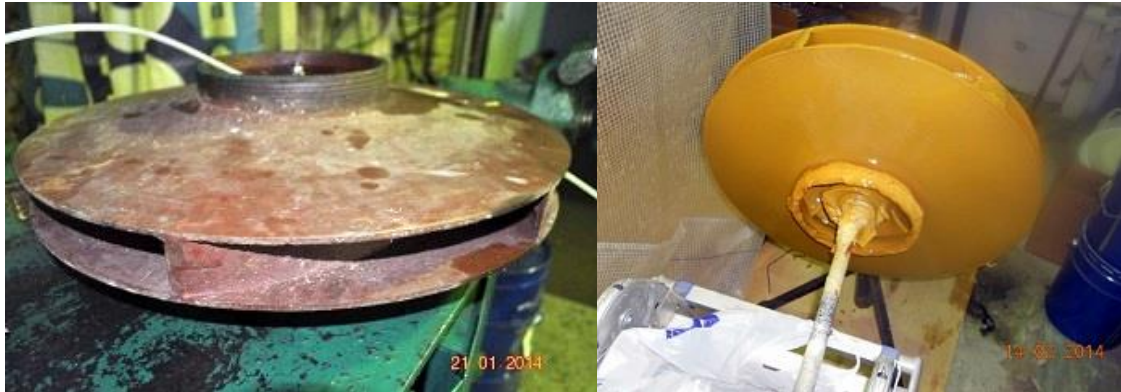
Рис. 3. Деталь до и после нанесения эластомерного покрытия [7]
