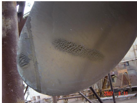
Рис. 2. Последствие кавитации на лопасти судового гребного винта [2]
