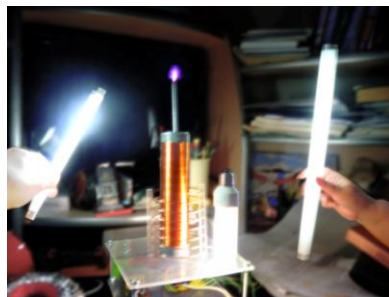
Рисунок 3. На фото видно как от трансформатора Тесла без проводов загораются лампы.
