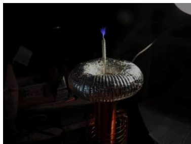
Рисунок 2. Модель трансформатора Тесла в работе. Гофрированное кольцо (торус) позволяет незначительно увеличить площадь высокочастотного электрического поля и придаёт трансформатору более классический вид.
