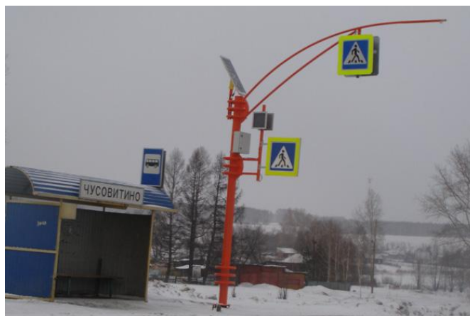
Рис.4. Светофор на солнечных батареях в п.Чусовитино Кемеровской области
