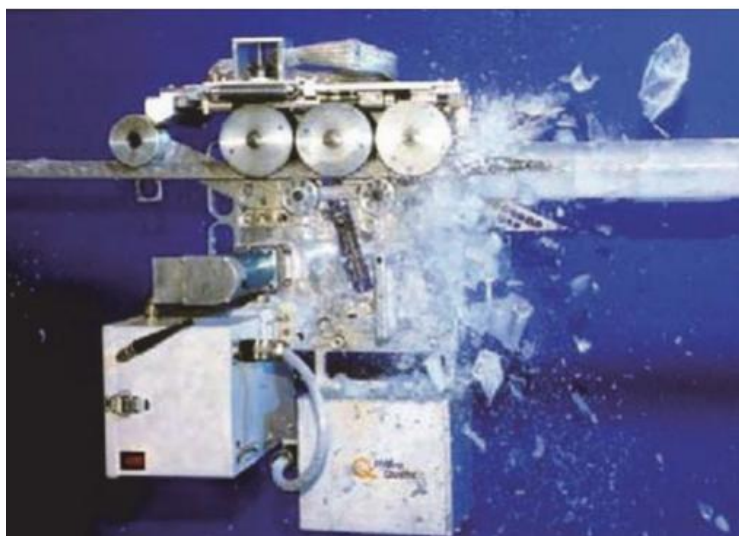
Рис. 5. Дистанционно управляемое устройство для механического удаления льда
