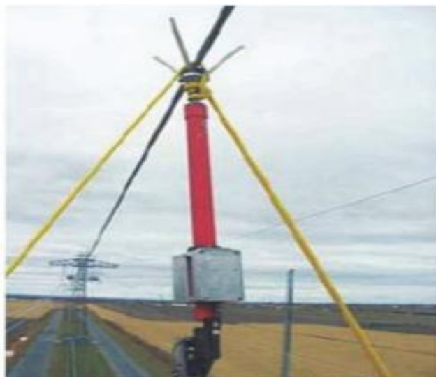
Рис. 4. Передвижное устройство для механического удаления льда
