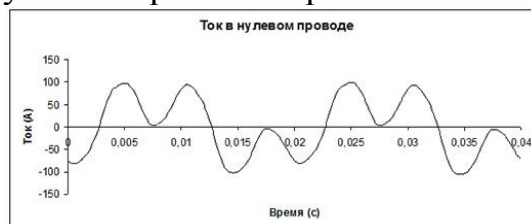
Рисунок 3 Кривая тока в нулевом проводе КТ
