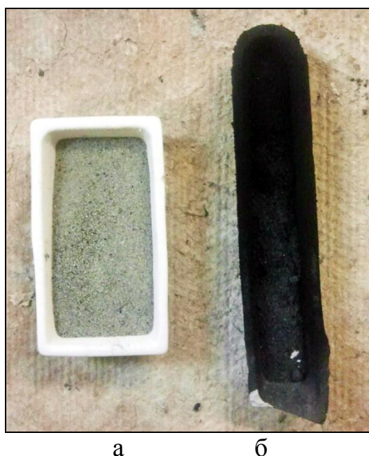
Рис. 1. Внешний вид образцов навески микросфердо (а) и после (б) нанесения пиролитического углерода
