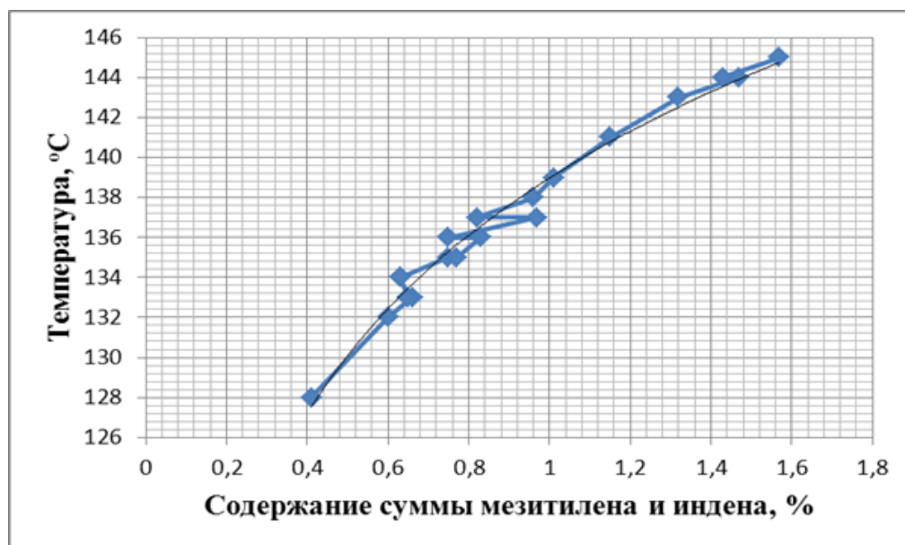
Рис. 1. График зависимости температуры конца 97 % отгона пробы БС-1 от суммарного содержания мезитилена и индена
