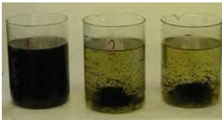
Рис. Действие флокулянта на угольные частицы
