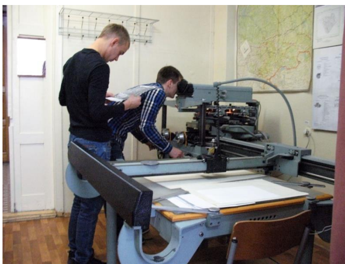
Рис.1. Наблюдение и измерение модели местности на СЦ-1 студентами ГМс
