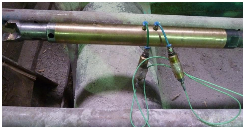
Рис. 4. Пневмоударник с подключенными пьезодатчиками
