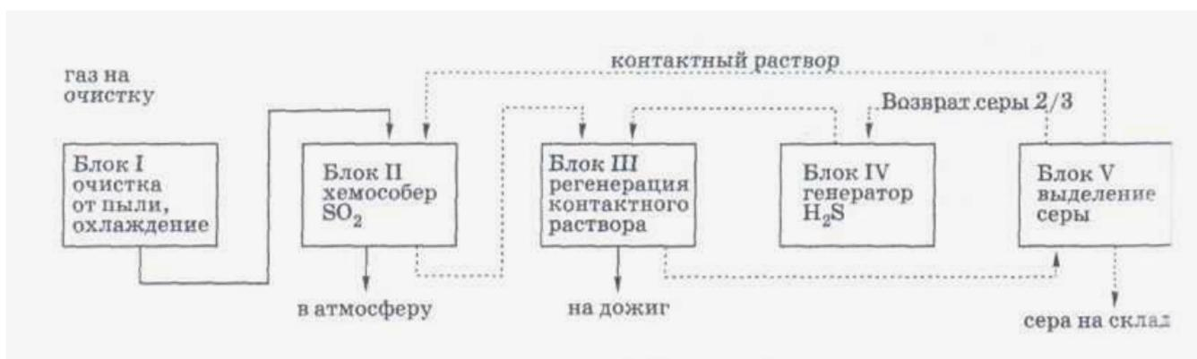
Рисунок 2. Блок-схема очистки газов от SO<sub>2</sub>
