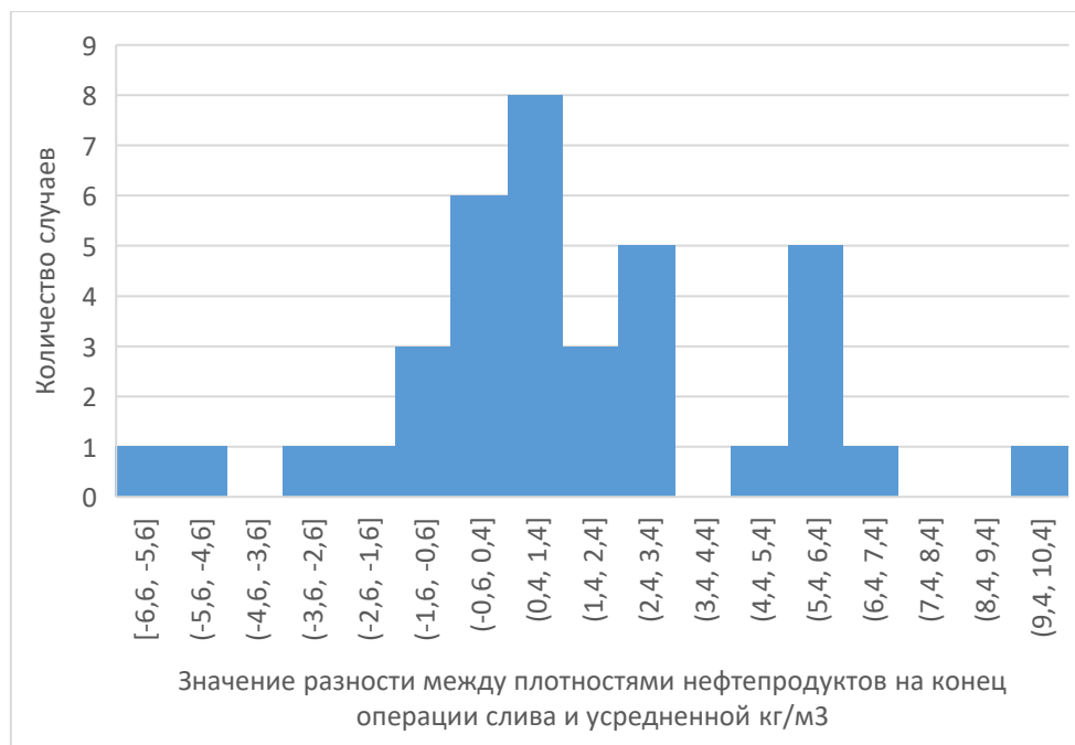
Рисунок 2 – Распределение разности плотностей в конце операции слива дизельного топлива в резервуары
