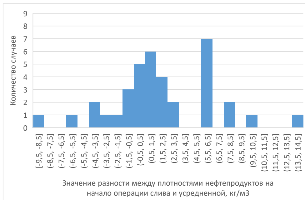
Рисунок 1 – Распределение разности плотностей на начало операции слива дизельного топлива в резервуары
