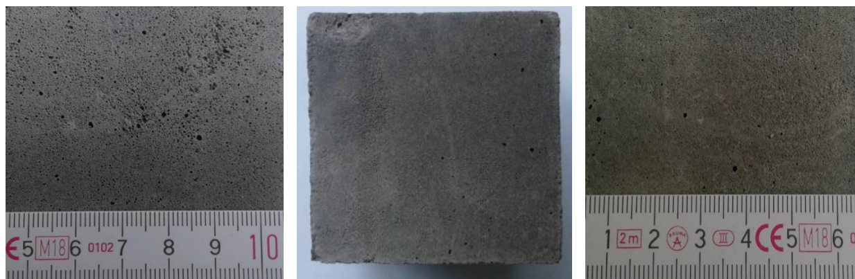
Рис. 2. Фото пенобетона на основе шлакощелочного вяжущего
